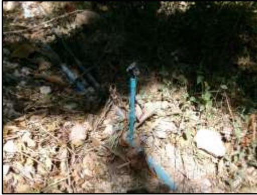
ภาพที่ 2.8 สปริงเกอร์ฉีดพรมน้ำบริเวณเส้นทางขนส่งแร่
